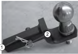
Federstecker ① Kupplungsbolzen ②
